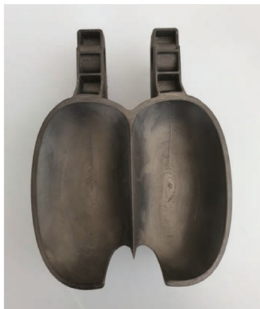
Prototipo in stampa 3D della paletta Pelton
